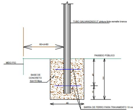
DETALHE FIXAÇÃO PLACA NO PASSEIO    DETALHE FIXAÇÃO DE HASTE DE SINALIZAÇÃO
