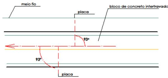
inclinação placa suspensa
