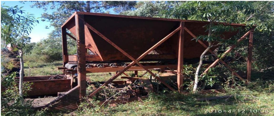
Uma MINI USINA DE ASFALTO SUCATEADA, duas caixa de mistura, sem motor, correia transportadora por roletes, caixa de produtos. Estado geral ruim. Valor R\$ 500,00 (quinhentos) reais.
