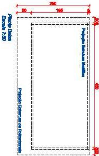
Descrição: Cobertura metálica com pintura vermelha coberta com polícarbonato COMPACTO 4mm cor cristal
